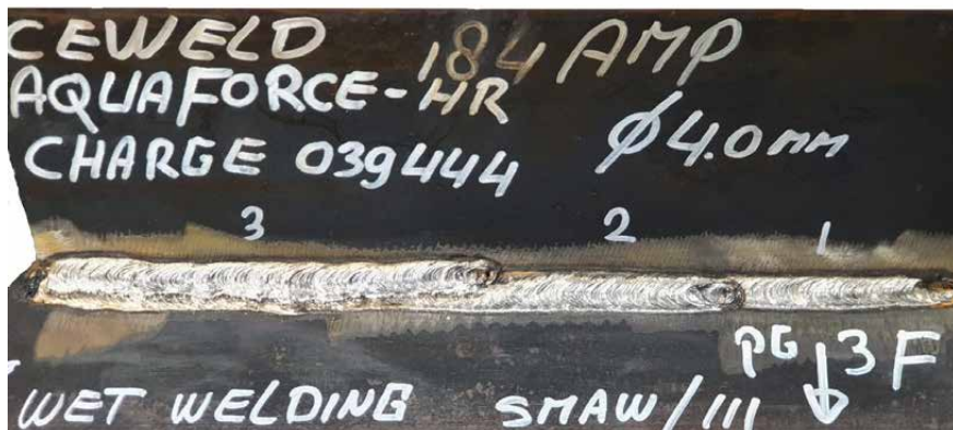
Kehlnaht fallend (PG / 3Fd) in 2 3 Lagen
