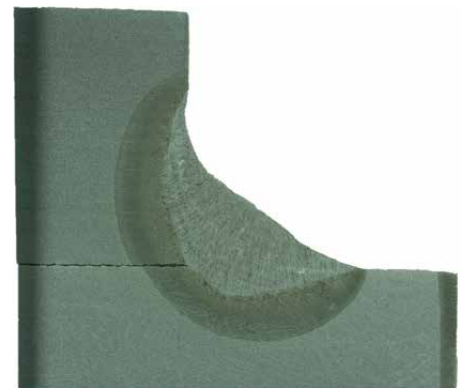
Makro einer Kehlnaht fallend (PG/3Fd) mit sehr gutem Einbrand
