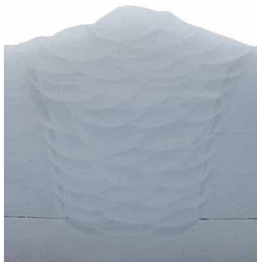
Makro eines reinen Schweißgutes ohne Poren
