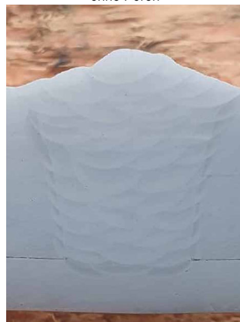
Makro eines reinen Schweißgutes ohne Poren
