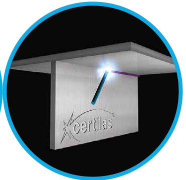
Achse der Schweißnaht Horizontal Überkopf-Position ASME : 4F ISO: PD
