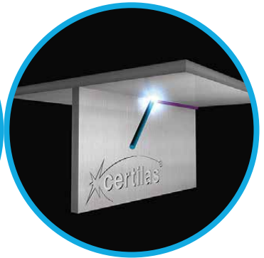
Achse der Schweißnaht Horizontal Überkopf-Position ASME : 4F ISO: PD
